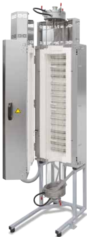
Horno tubular RSV 170/1000/11 con tubo de trabajo de cristal de cuarzo estanco al gas y bridas de vacío refrigeradas por agua
