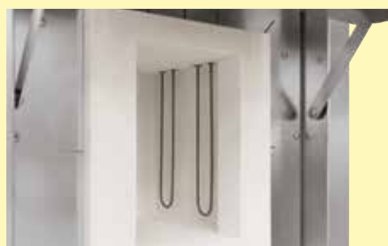
Elementos calefactores de alta calidad de disiliciuro de molibdeno
