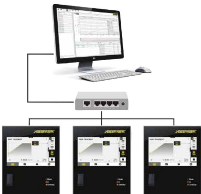
Ejemplo de instalación con 3 hornos
