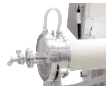
Brida de vacío refrigerada por agua (sistema de alimentación de gas 2)
