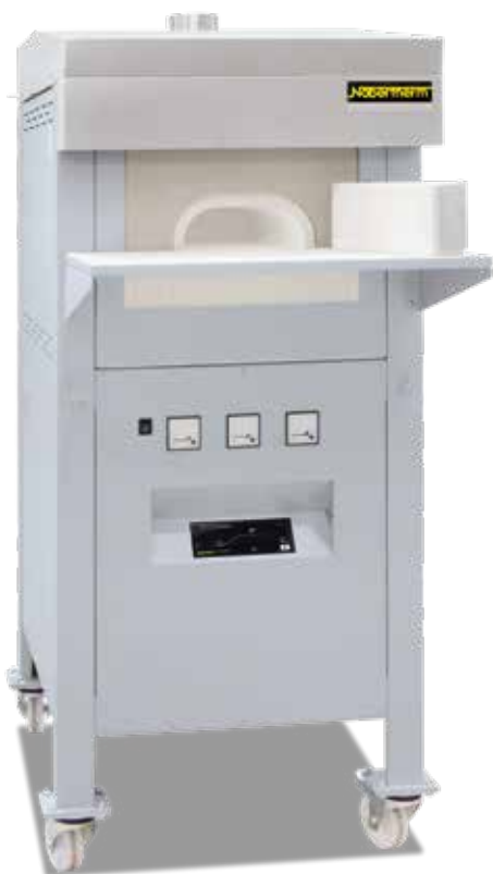
Horno de copelación N 10/13 CUP con ladrillo de cierre y soporte sobre ruedas
