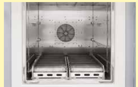
Rodillos en la cámara del horno
